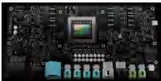
图 5 辅助驾驶平台硬件实物图
