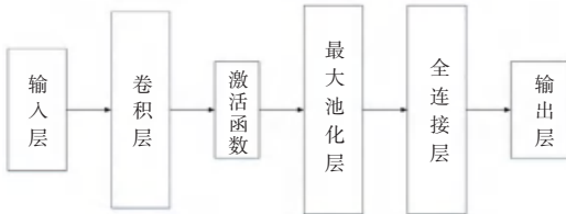
图2 CNN网络结构
